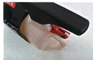
レバー式開始ボタン・ロック状態。
